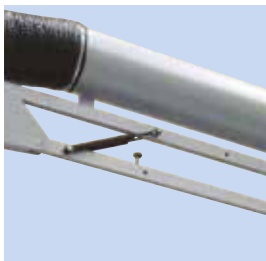
Gasfedern Arm ist mit Gasfedern ausgewuchtet.
