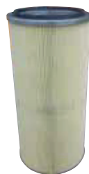
Patronenfilter Feinfiltration durch selbst-reinigende Filterpatronen erhöht intervall zw. den erforderlichen Filterwechsln. (Normale Lebenszeit 2000-6000 Stunden.)
