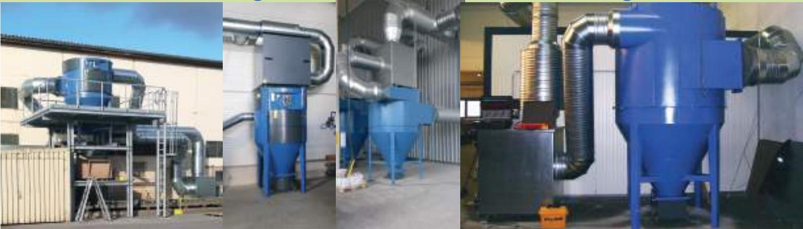
Die Filteranlage VAUPEL ACF ist eine zweistufige Filteranlage. Über den tangentialen Eintritt werden die Grobpartikel sowie auch Späne abgeschieden. In der zweiten Stufe wird über hochwirksame Filterpatronen die Luft so gereinigt, dass diese auch in den Arbeitsbereich zurückgeführt werden kann. Die ACF wird auch in W3-Ausführung gebaut.
