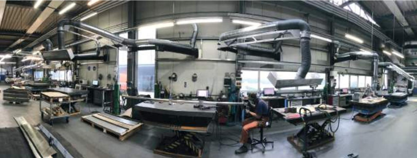
Hier ist die schwenkbare und freitragende VAUPEL Absaughaube Typ LE im Einsatz. Mit einer Breite von 1.500 mm sowie einer Tiefe von 300 mm, werden Rauch und Staub an der Entstehungsstelle erfasst, in den meisten Fällen ohne die Erfassung umsetzen zu müssen. Eine Erfassung, die Ihresgleichen sucht. Mit einer Reichweite von 6.000 mm, können bis zu 12.000 mm Arbeitsbereich erfasst werden.
