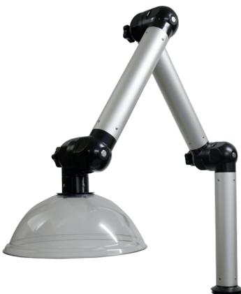
Der Absaugarm Typ LA-3-ST ist aus robustem, eloxierten Aluminium hergestellt. Er wird vorwiegend in Laboren eingesetzt. Durch den Flanschanschluss kann er direkt auf einen Tisch montiert werden. Eine Konsole zur Tisch- oder Wandmontage ist optional erhältlich. Der Arm ist mit einer Klarsicht-Trichterhaube ausgestattet. Durch die durchgängige Ausführung aus Metall, ist eine Erdung möglich.
