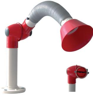
Der Absaugarm VAUPEL LA-1-F ist aus säurebeständigen Materialien (PP und Edelstahl) hergestellt. Er wird vorwiegend in Laboren eingesetzt. Durch den Flanschanschluss kann der Arm direkt auf einen Tisch montiert werden. Eine Konsole zur Tisch- oder Wandmontage (bereits im Lieferumfang enthalten) ist optional erhältlich. Der Arm hat eine eingebaute Absperrklappe. Eine Trichterdüse DN 200 mm ist ebenfalls im Lieferumfang enthalten.
