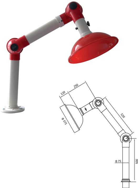
Der Absaugarm VAUPEL Typ LA-2-S ist aus säurebeständigem Material (Polypropylen (PP)) gefertigt. Durch die Tischkonsole ist er um 360° drehbar. Der Absaugarm wird in einem definierten Bereich am Arbeitsplatz eingesetzt. Der Durchmesser ist so gewählt, dass der Luftwiderstand und somit der Energieaufwand sowie der Geräuschpegel minimiert wird. Eine dichtschießende Klappe birgt die Möglichkeit, mehr Arbeitsplätze bei geringerer Gleichzeitigkeit zu versorgen.
