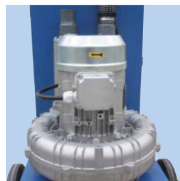
Seitenkanalgebläse Auf Schwingungsdämpfern montiert und durch Flex-Verbindungen zum Filtergehäuse verbunden.
